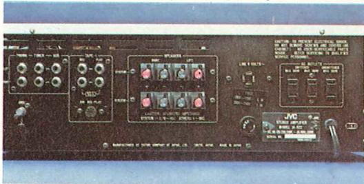
*Sul pannello posteriore si notano il cambiatensioni, il fusibile di rete e tre prese ausiliarie. Nella foto a destra il bel trasformatore su cui sono chiaramente indicate le tensioni di ingresso e di uscita.*
