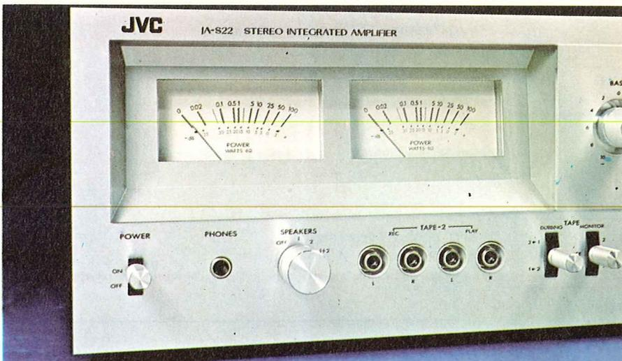
Sul frontale del JA-S22 spiccano i due VU incassati in una vetrinetta rettangolare, la presa per la cuffia e le prese per il secondo registratore. Ciò rende possibile il collegamento « volante » di una piastra per effettuare, per esempio, un riversamento.
